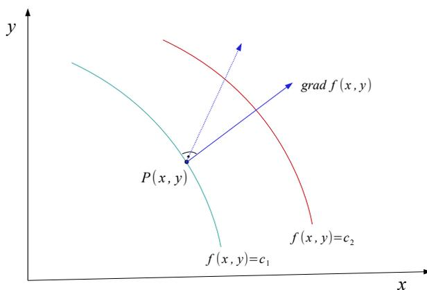
**Abbildung 1.11** Gradient  $\text{grad } f(x, y)$
