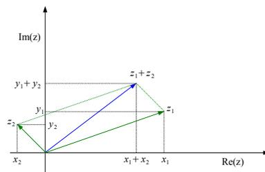
**Abbildung 2.11** Zeigerdiagramm und Addition komplexer Zahlen
