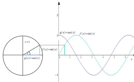
**Abbildung 1.11** Die Funktionen sin und cos und der Einheitskreis
