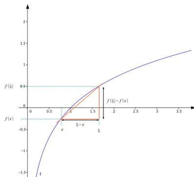
**Abbildung 4.13** Die Steigung der Sekante
