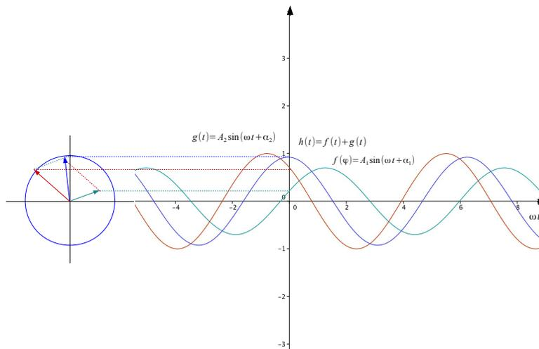
**Abbildung 2.13** Addition sinusförmiger Schwingungen, Teil II
